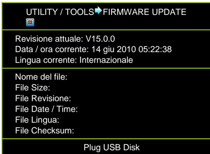
Una volta che il dispositivo USB è collegato alla porta, il DVR necessita alcuni secondi per cercare il firmware.
