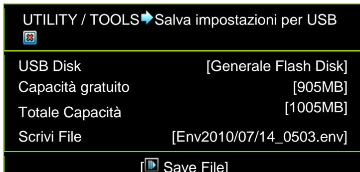
Questo strumento può essere consentito di duplicare la configurazione di sistema e salvare sul dispositivo USB. Utilizzare questa funzione per distribuire rapidamente i sistemi DVR altri che intendono utilizzare la stessa configurazione.
